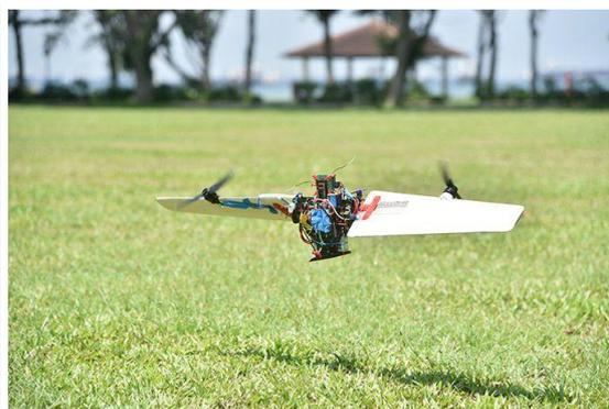
マルチロータータイプ（3つ以上のプロペラを搭載して飛行するタイプ）のドローンは、安定して長距離や重い荷物を運ぶのに向いているものの俊敏性に欠け、一方、グライダーのような固定翼タイプは、俊敏性はあるものの、クルージングやホバリングするのには向かない。前頁の図・写真は THOR の一例である。それぞれのタイプのドローンが抱える課題を解決するドローン、つまり全翼ドローンで理論上の機械効率は最も高い。
