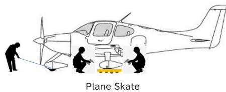
①(シナリオ3)片側メインギアにフラットタイヤ発生という前提でメインギアにプレーンスケートのロープをセットして手動で巻き上げる作業ができるか。
