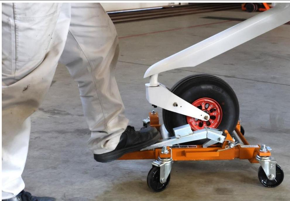
ドーリーに装備されている足踏み式のジャッキで機体(タイヤ)を持ち上げて自動的にドーリーを滑り込ませる。
