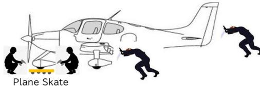
①ノーズギアにフラットタイヤ発生という前提でノーズギアにプレーンスケートのロープをセットして手動で巻き上げる作業ができるか。
