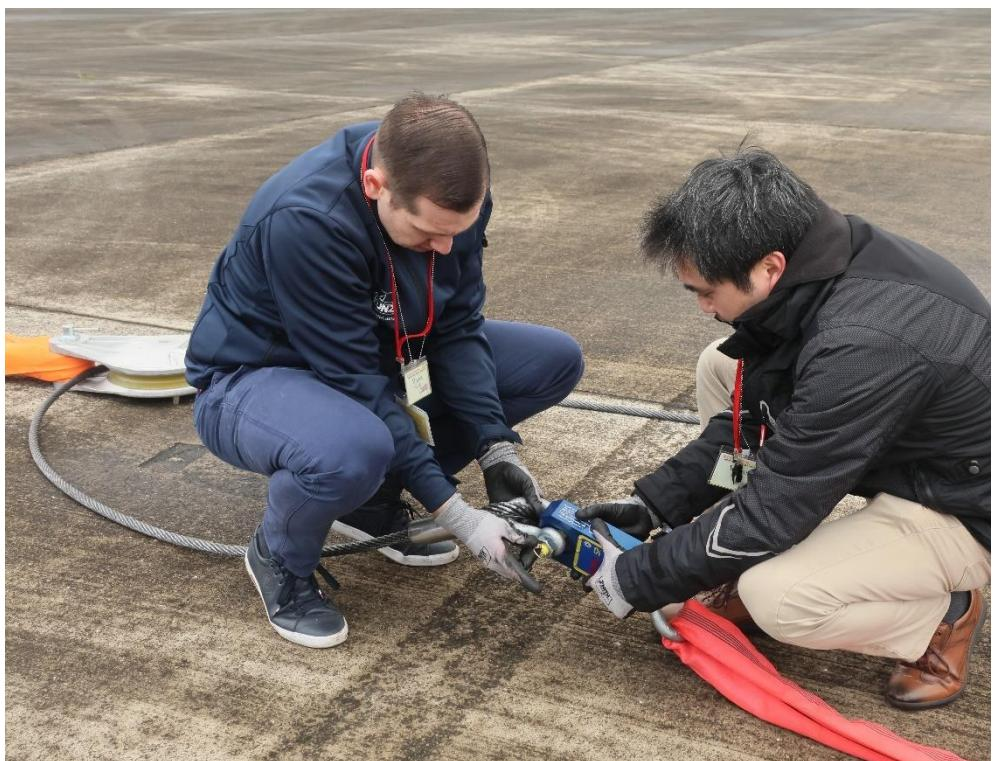
※牽引計(ロードセル)の設置作業
