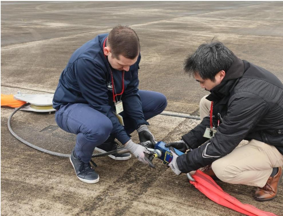
※牽引計(ロードセル)の設置作業
