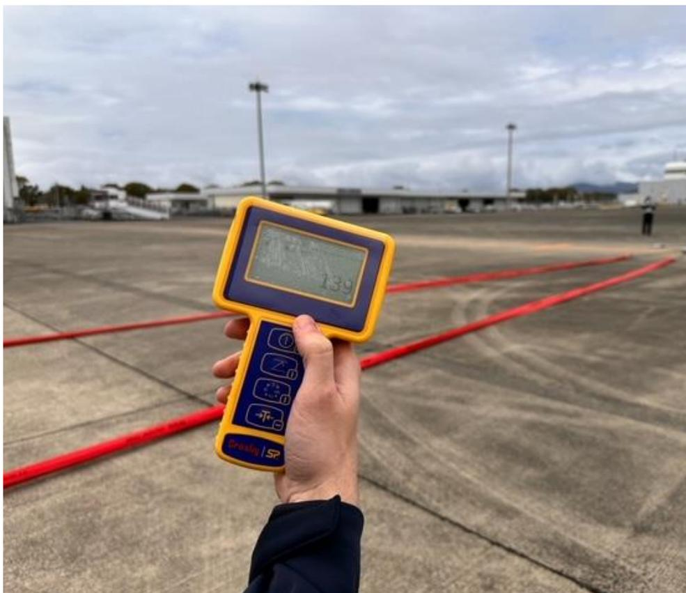
牽引計(ロードセル)の数値が表示器にリアルタイム、最大値が表示される。
