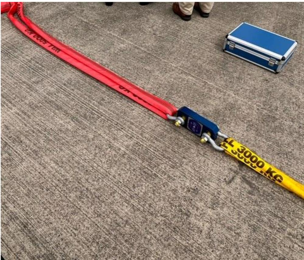
ロープとロープの間に牽引計(ロードセル)を設置
