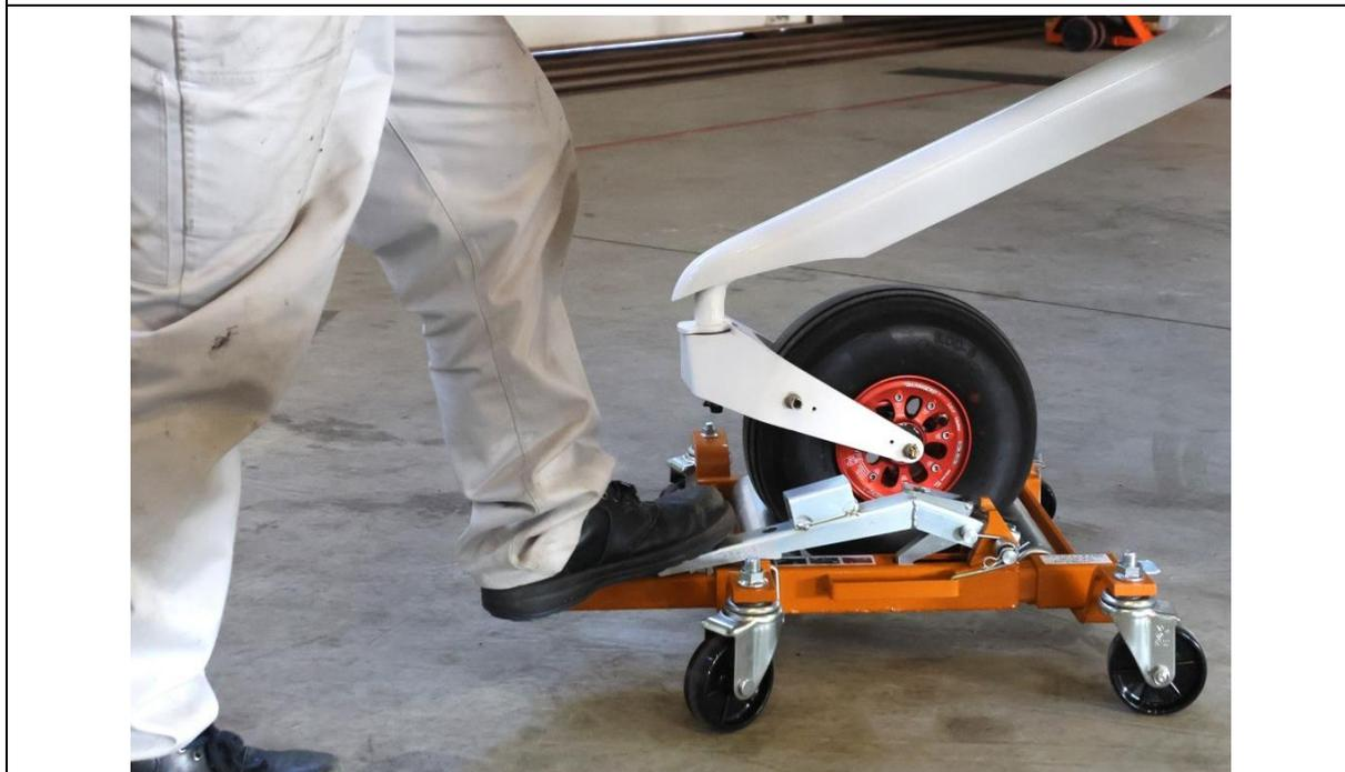
ドーリーに装備されている足踏み式のジャッキで機体(タイヤ)を持ち上げて自動的にドーリーを滑り込ませる。
