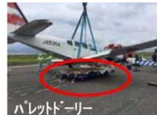
⑥ トランスポートローラー及びベルト荷締機
